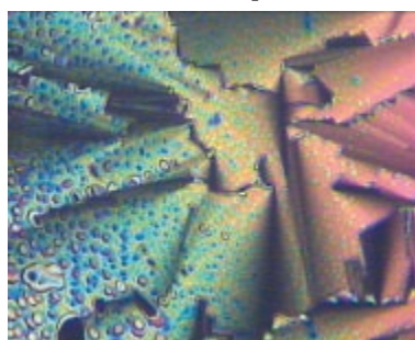
Поляризационни микрофотографии на лиотропни течни кристали (ИФТТ – БАН). Polarizing microscopy images of lyotropic chromonic liquid crystals (ISSP-BAS).
